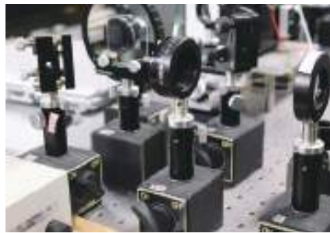
光受容タンパク質の光反応を調べるためのレーザー分光システム
