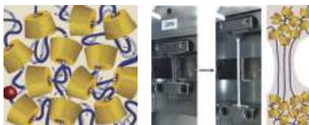
図1 直鎖状高分子と環状分子のネックレス状複合体から作られたプラスチック。環状成分が形成するフレーム内を高分子鎖が運動し(左)、材料の延伸に伴い高分子鎖が引き出されることで、応力集中による脆性破壊が回避できる(右)。
