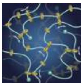
架橋点が自由に動く環動高分子材料。コーティングや防振材など、様々な分野への応用展開が進行中。
