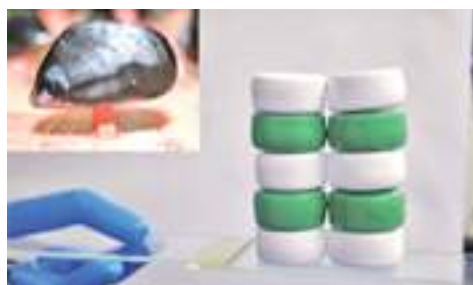
図2 ムラサキイガイの接着性タンパク質をモチーフとした接着性高分子材料。
